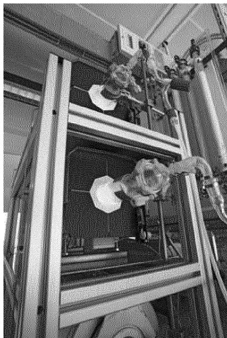
In diesen Öfen treiben Chemiker des MPI für Festkörperforschung bei rund 600 Grad Celsius organische Substanzen aus dem Polymer, sodass sich die Keramik bildet.
