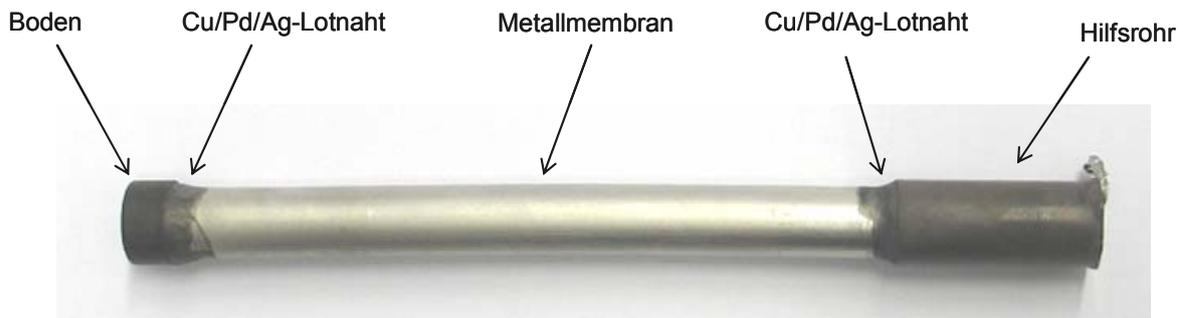
**Abbildung 4-3:** Palladium-Metallmembran mit Stahlstopfen an beiden Enden
