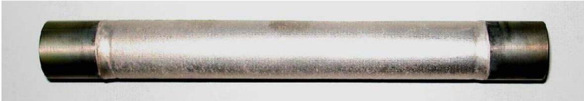
**Abbildung 2-21:** Sintermetallmembran, Palladium beschichtet [SCH2006]
