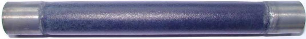
**Abbildung 2-20:** Sintermetallmembran vor der Palladium-Beschichtung [SCH2006]
